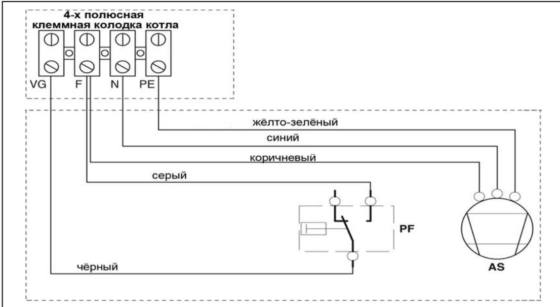
PF = Датчик давления дымовых газов;
